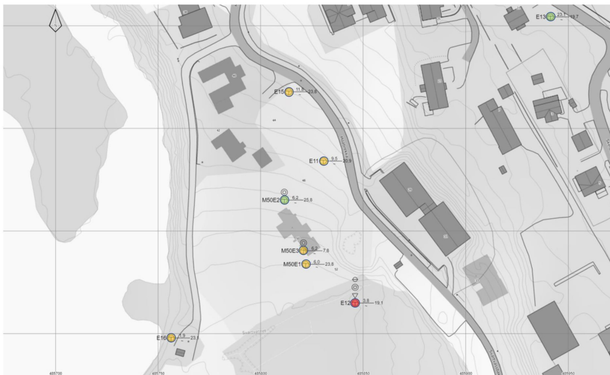
Figur 4 Oversikt over boringer og funn av sprøbruddmateriale. Rød = bekreftet sprøbrudd, Gul = ikke avklart hvorvidt det er sprøbrudd, Grønn = tolket/bekreftet ikke sprøbruddmateriale.
