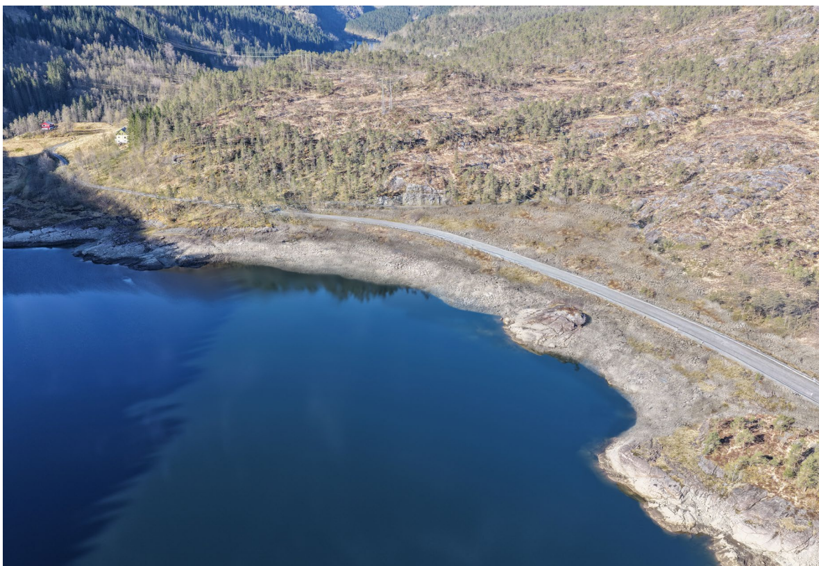
Figur 6 Grønsdalsvatnet vest rett etter anleggsperiode/deponering. Justert fylkesvegtrase på tippen. Vannstand +189 (1 m over LRV).
