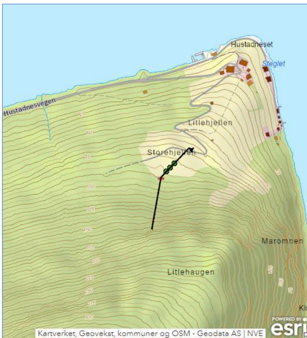
Figur 8 Kart som viser utlaup av steinsprang berekna med Alfa-Beta metoden
