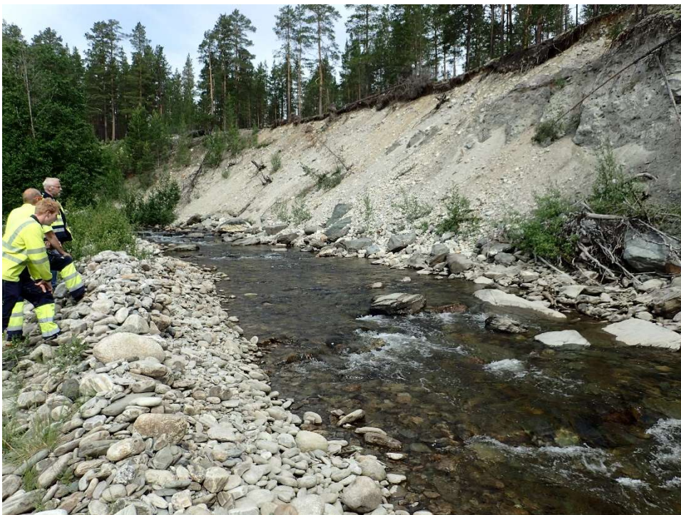
Figur 17 Bilde F, bratt skråning i yttersving, aktiv erosjon
