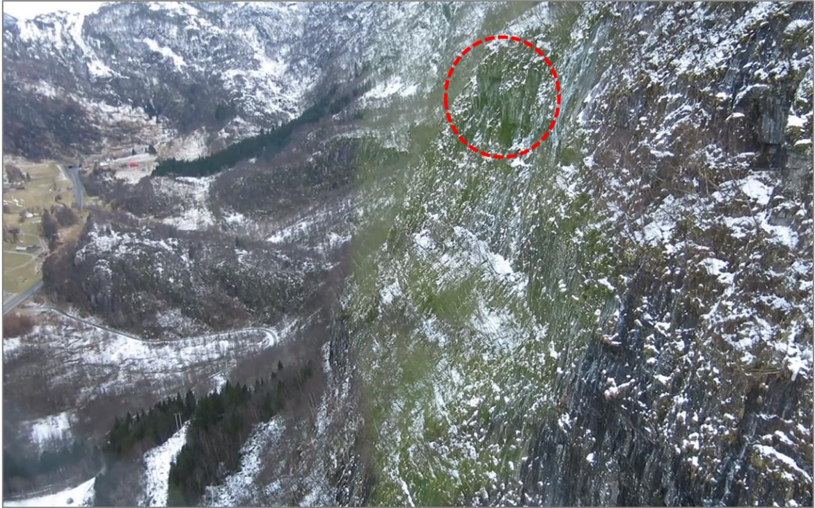
Bilde 3. Helikopterbilde mot nordøst over den aktuelle delen av skråningen ovenfor skoleområdet. Et større potensielt ustabilt bergparti er markert med en stiplest sirkel.
