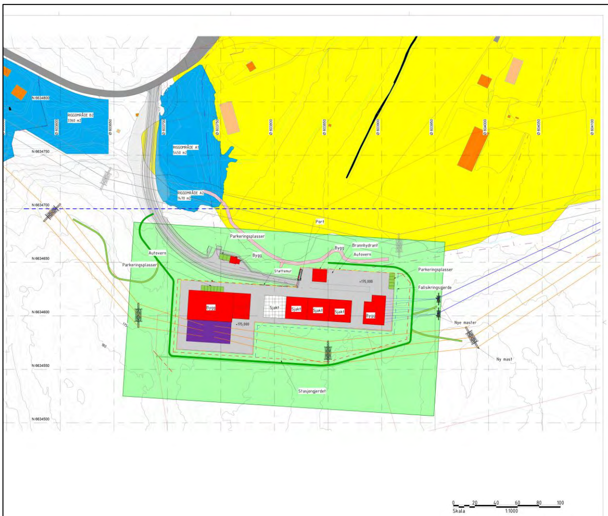
Figur 2-1: Foreløpig situasjonsplan for Liåsen transformatorstasjon, alternativ A.
