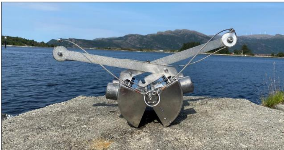
Figur 2: Van veen grabb (illustrasjonsbilde), egnet for prøvetaking av sediment.
