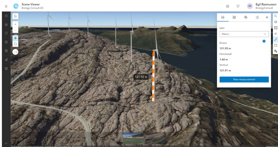
Figur 15 Eksempel på innsynsmodell hvor en kan gjøre kommentarer og ta ut mål
