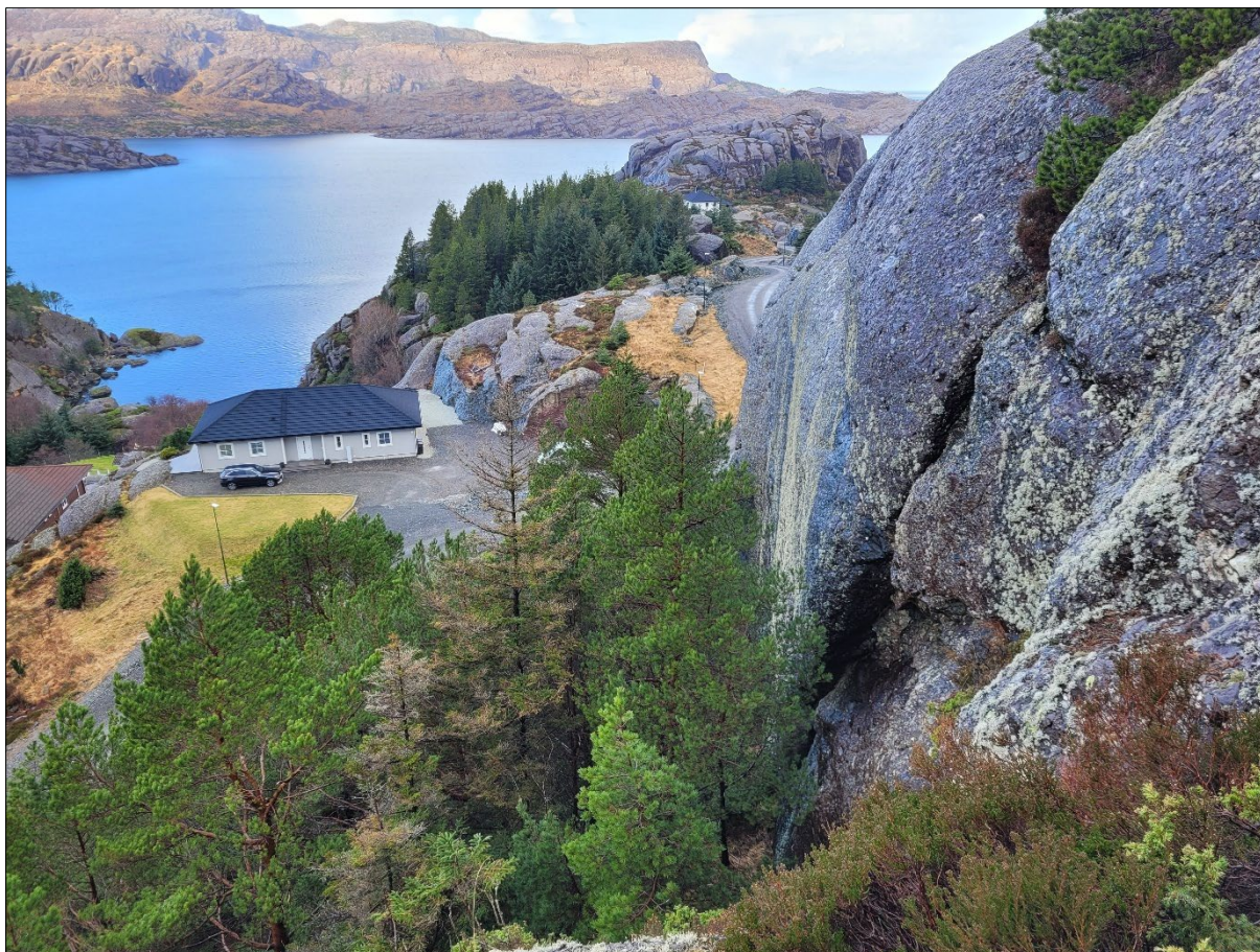
Figur 11: Overflata til konglomeratet er massiv med avrunda former etter langs tids forvitring, noko som indikerer lite oppsprekking og tidlegare utrasingar.
