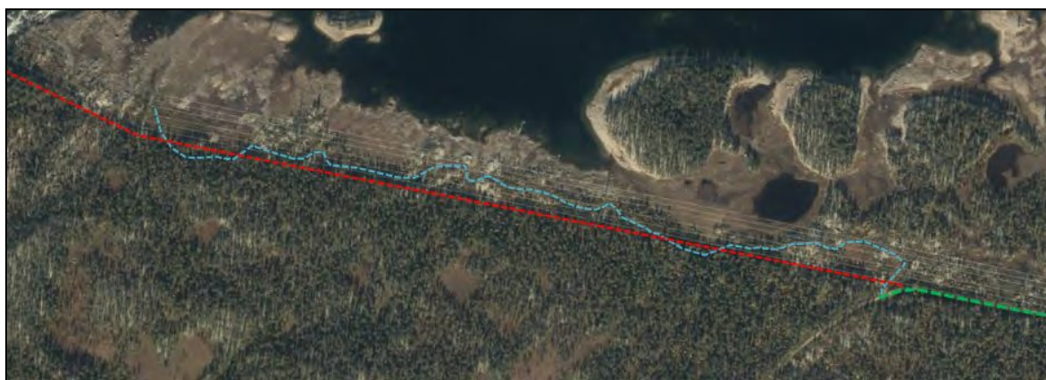
Figur 4: Utsnitt fra norgeskart.no viser ryddebeltet langs 420 kV traséen der Statnetts adkomstvei, blå linje følger under linjen. Rød linje er foreslått trasée i byggeforbudsbeltet 10 meter fra ytterste fase mot sør. Endelig horisontal- og vertikal må tilpasses noe, men vil holdes innenfor byggeforbudsbeltet.
