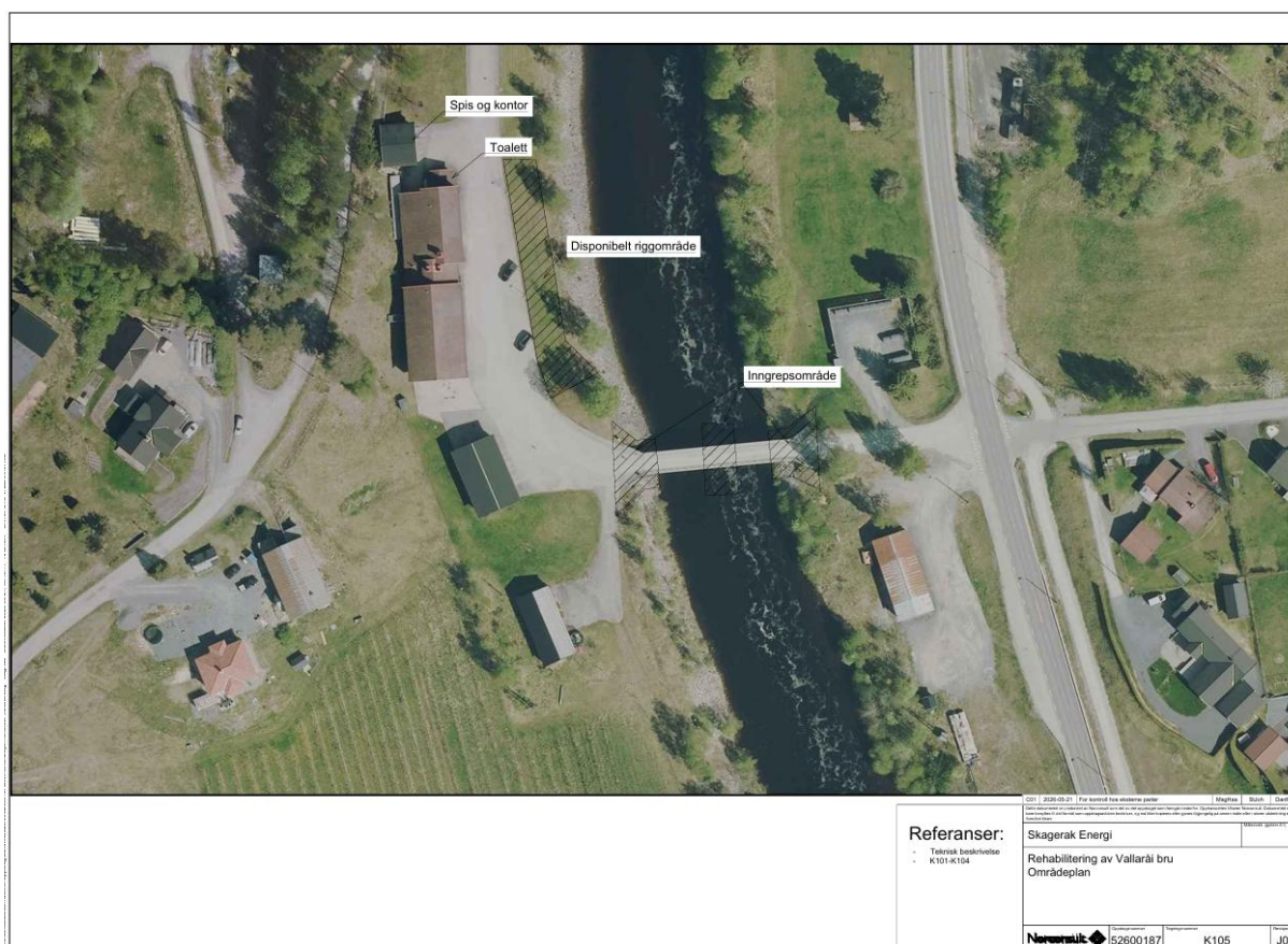
Figur 2: Oversiktsbilde over bru Vallaråi. Skraverte områder viser hvilke områder av brua det skal utføres rehabilitering på.
