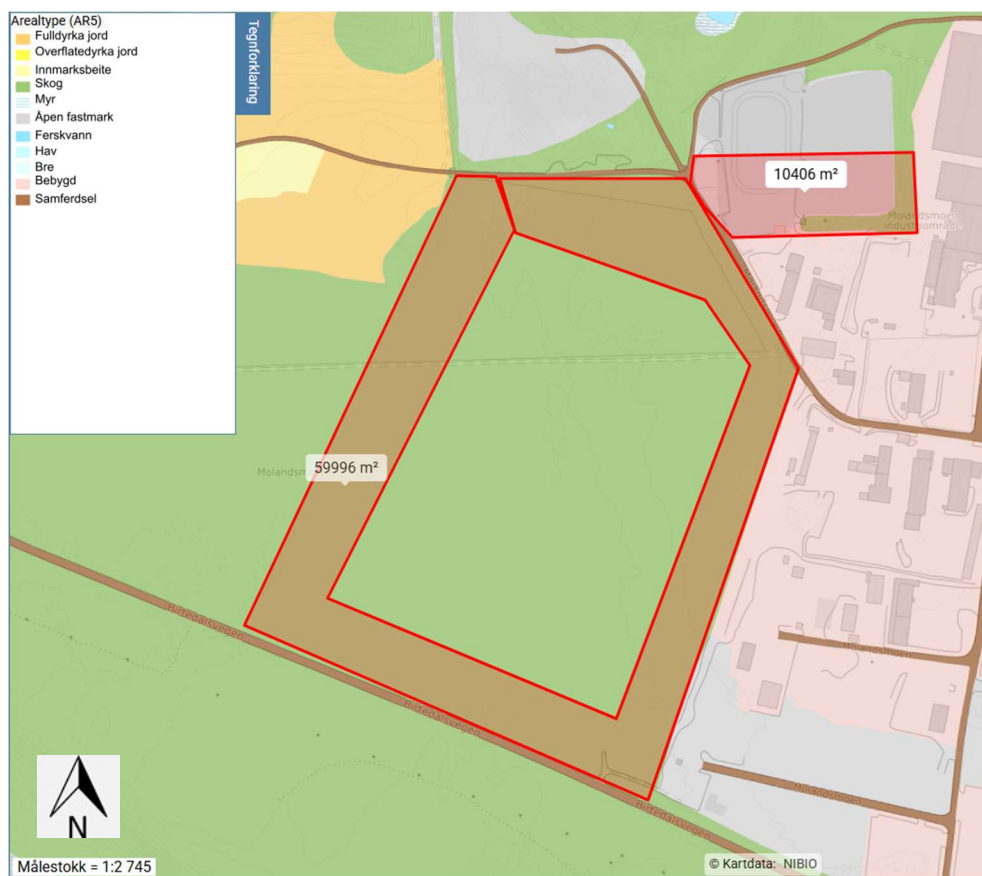
Figur 6 Oversikt over arealbeslag for Molandsmoen transformatorstasjon og område for 22kV koblingsanlegg (stasjoner og grøfter). Arealtyper innenfor området som ønskes utbygd er for det meste skog og åpen fastmark (Kartgrunnlag: NBIO/Kilden)
