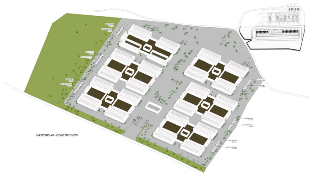
Figur 18 Tiltakets utstrekning: koblingsanlegg, sju transformatorer og seks databygningsblokker
