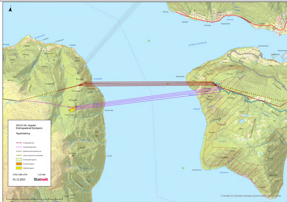
Figur 1: Oversiktskart for fjordspenn over Sognefjorden. Jarvehaugen i Vik kommune ligger på vestsiden. Bjørnstigkamben i Sogndal kommune ligger på østsiden. Øverst, med røde streker, er dagens 300 kV ledning mellom Sogndal og Hove. Nederst, med lilla streker, er ledningen som Statnett nå søker om.
