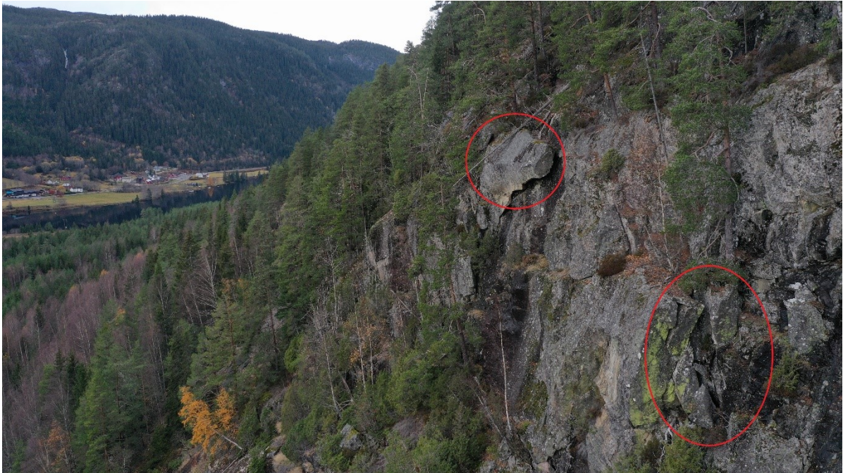
Figur 15. Potensielle blokker markert i rødt ved Vikeskotet over Åraksvegen.
