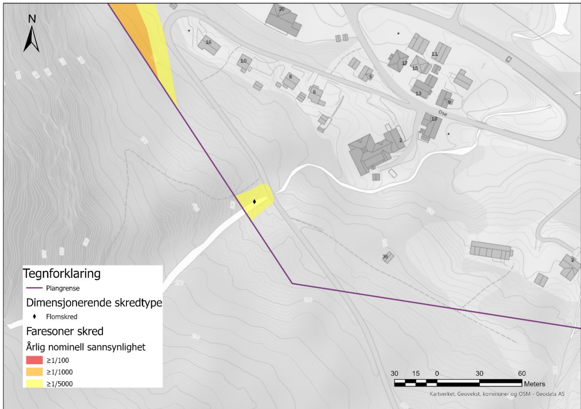
Figur 19: Faresone for flomskred ved Fossabekken.
