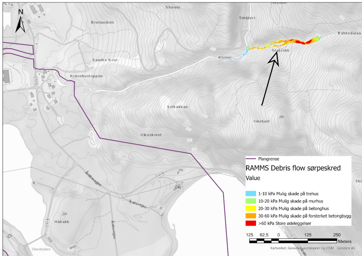
Figur 21. Resultater fra modellering av sørpeskred i RAMMS utenfor planområdet (oppe til høyre i bildet).
