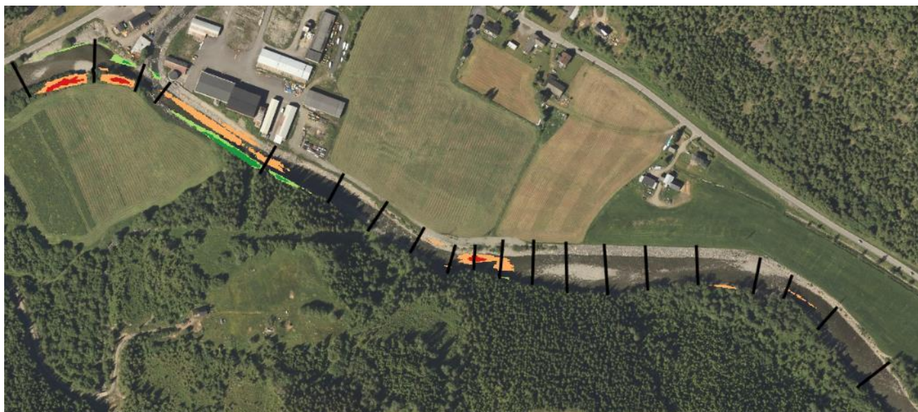
Figur 8-5 Terrengnivå fra tverrprofil oppmålt i 2021 minus laserskannet 2019
