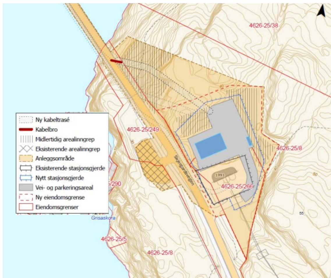
Figur 5. To muffehus på Solsvik, utvidet stasjonsgjerde og teknikkhus.
