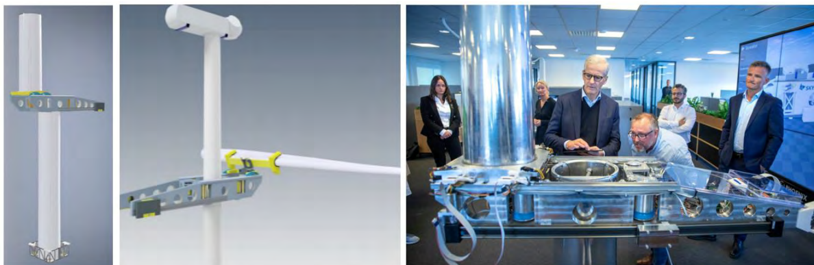
Figur 9. Illustrasjonen til venstre viser installasjon av tårnseksjon og turbinblad ved bruk av SkyWalker teknologi. Bildet til høyre viser en nedskalert versjon av teknologien som testes av Jonas Gahr Støre på besøk hos Nekkar i Kristiansand, våren 2022.
