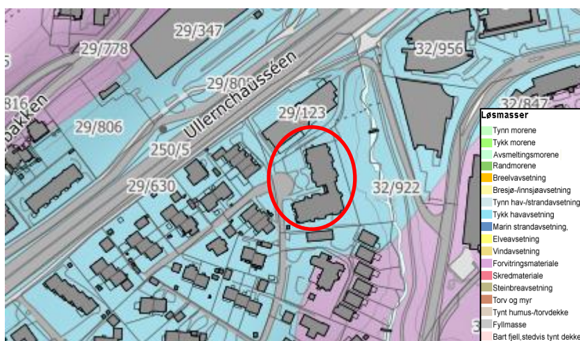
Figur 4 – Løsmassekart over Hoffsveien 50, planområde markert med rød ring. Hentet fra http://geo.ngu.no/kart/losmasse_mobil/
