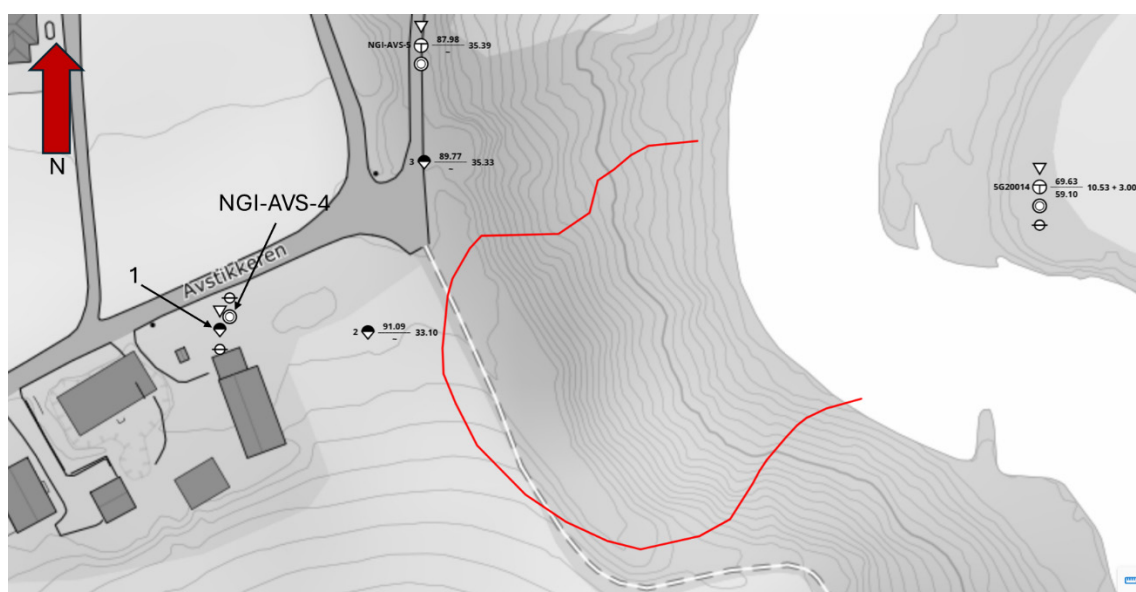
Figur 4-1: Det er utført grunnundersøkelser ved Avstikkeren 201 og 203 ved tre anledninger. Undersøkelser i borpunkt 1, 2 og 3 er utført av Løvlien Georåd/Akershus Grunnboring (oktober 2023). Undersøkelser i borpunkt NGI-AVS-4, NGI-AVS-5 og NGI-AVS-6 er utført av NGI i september 2024, ifm. pågående prosjekt (NGI, 2024). Kotene som vist på kart er fra før første skredhendelse (dvs. før oktober 2023). Borpunkt SG20014 på østsiden er utført av NGI ifm. bygging av Ringeriksbanen (NGI, 2019). Den røde linjen viser skredkanten til det andre skredet.
