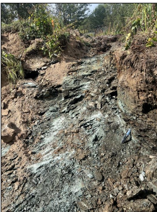
Figur 6: I prøvegrop 4 ble ytterligere bergoverflate gravd frem. Venstre bilde: Helt til høyre i bildet vises løsmassedekket i profil som ligger over berg(kniv for skala). Høyre bilde: oversiktsbilde av prøvegrop 4 der bergflate er gravd frem.
