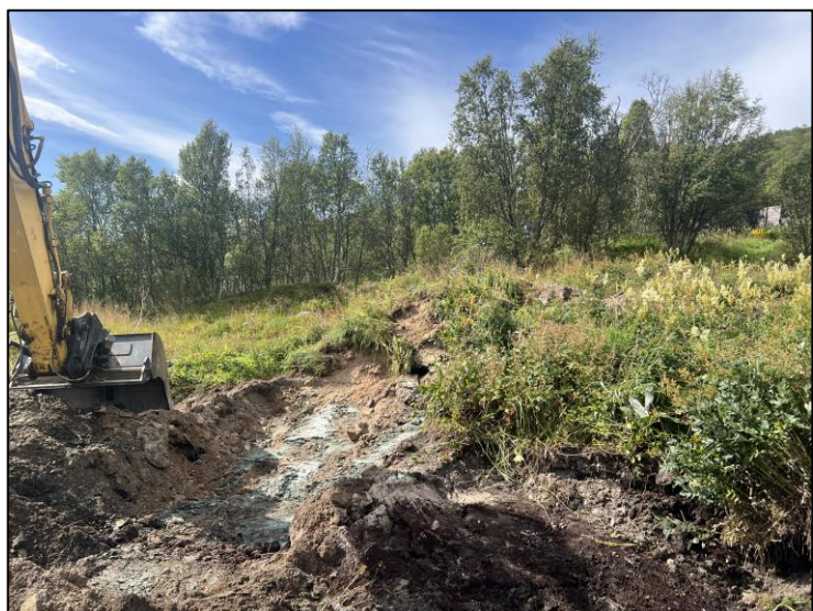
Figur 6: I prøvegrop 4 ble ytterligere bergoverflate gravd frem. Venstre bilde: Helt til høyre i bildet vises løsmassedekket i profil som ligger over berg(kniv for skala). Høyre bilde: oversiktsbilde av prøvegrop 4 der bergflate er gravd frem.
