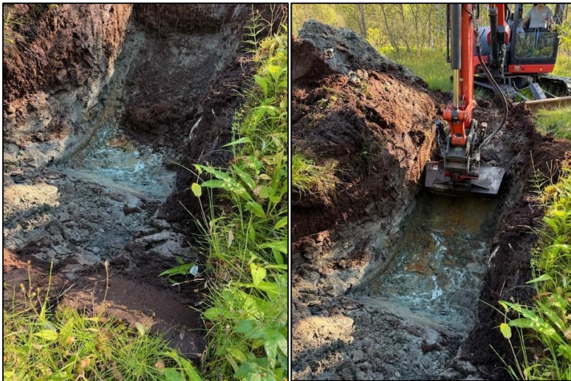
Figur 7: Prøvegrop 5. Gravd ned til berg. Øverste lag med torv deretter sandig, leirige masser over berg.
