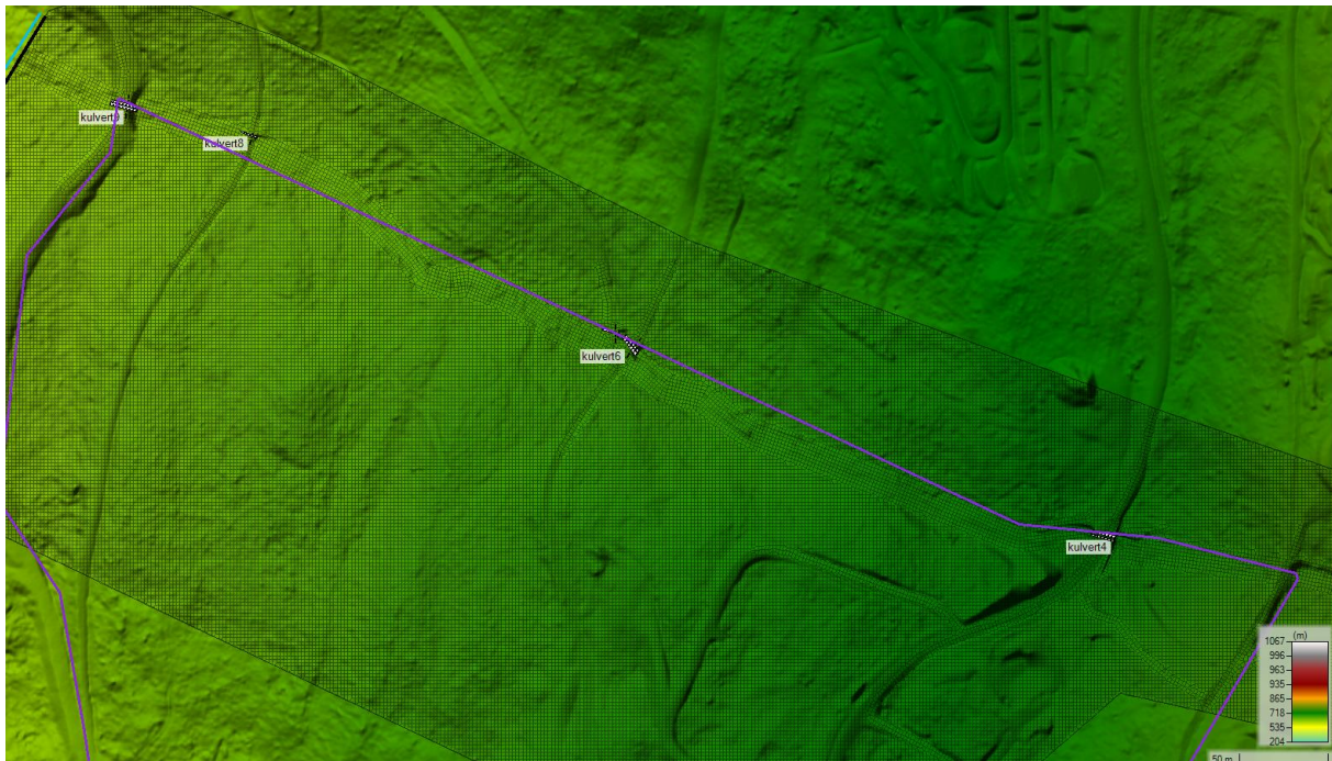
Figur 8: Illustrasjon av terrengmodell, beregningsgrid og plassering av nedstrøms grensebetingelse for mesteparten av modellen over Stubberudbekken.
