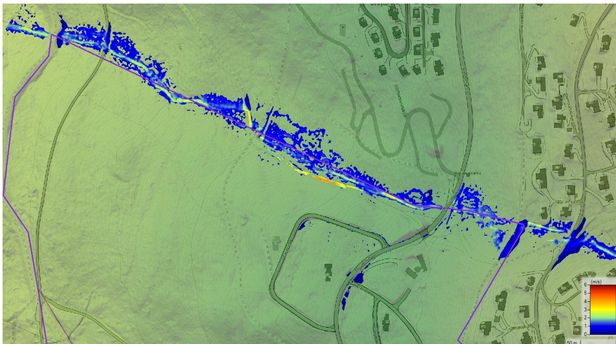
Figur 10: Illustrasjon av modellert strømningssituasjon ved en 200-årsflom inkludert klimapåslag for Stubberudbekken. Vandybder større enn 5 cm vises.
