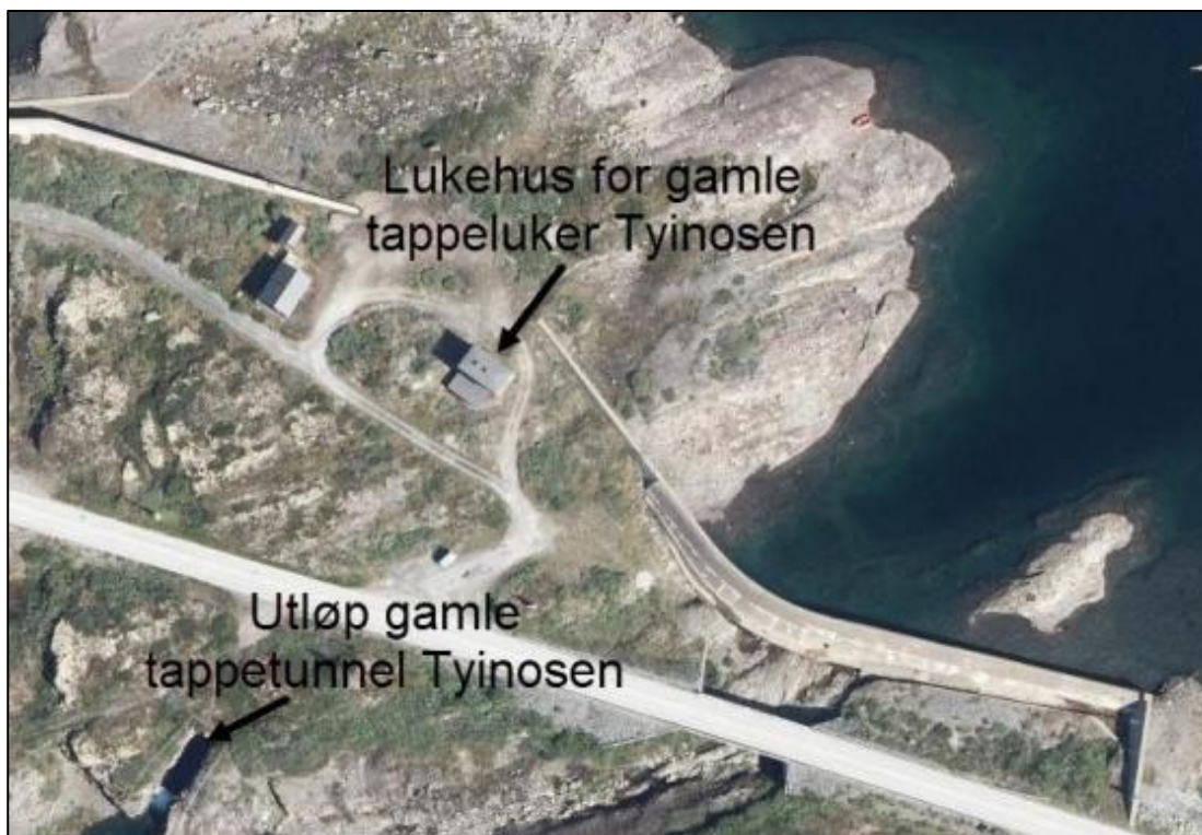
Figur 1-1: Plassering lukehus og tappetunnel for minstevannføring.
