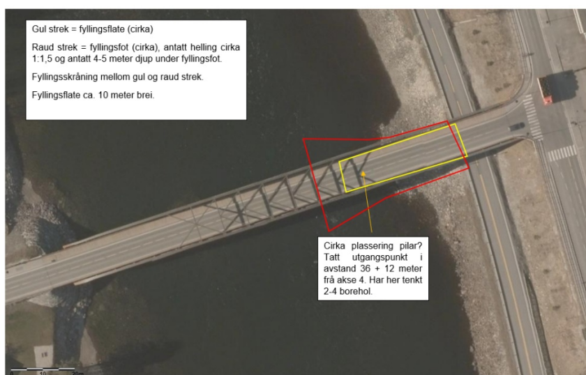
Figur 18. Skisse for utfylling på østsiden av Lågen. Gul markering er topp fylling og rød markering er fotavtrykket på elvebunn.
