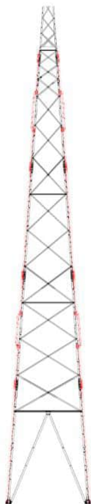
Figur 29 Eksempel på forsterkning av eksisterende master
