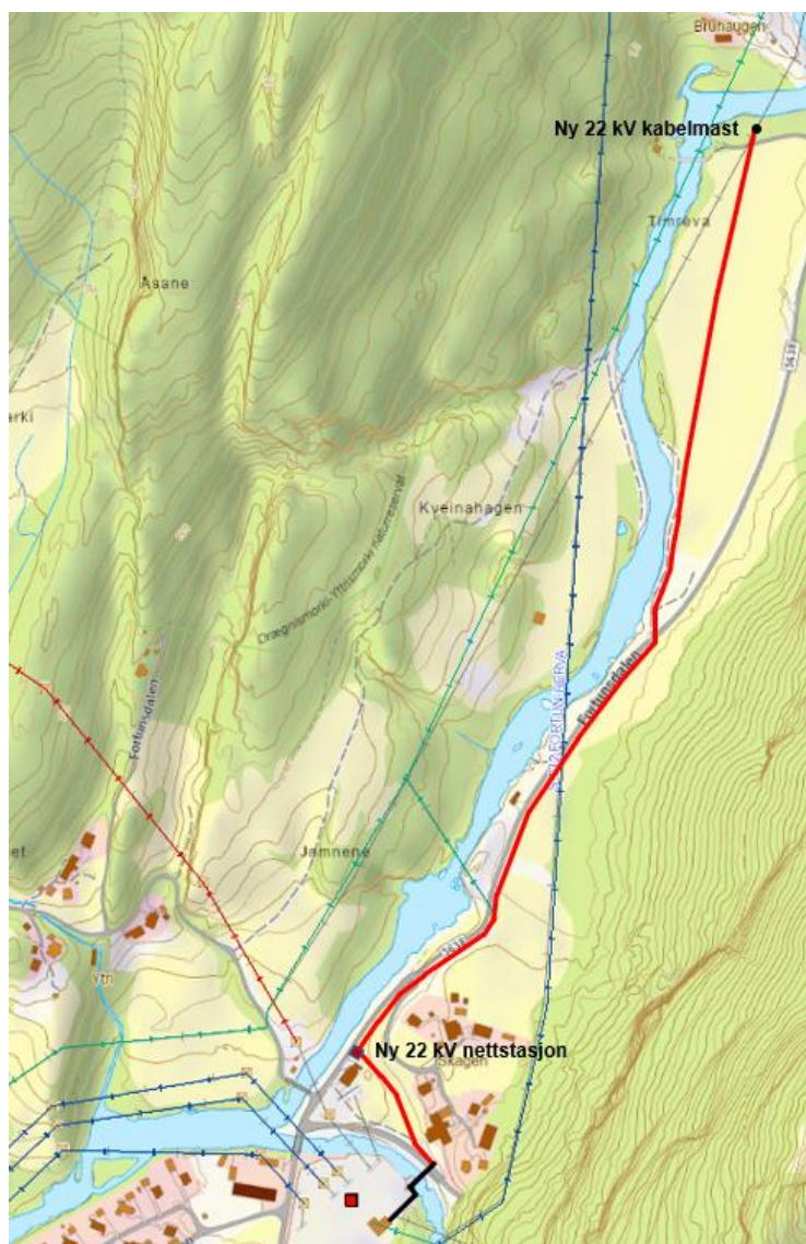
Figur 10: Omsøkt trasé mellom Skagen transformatorstasjon og Bruhaugen.
