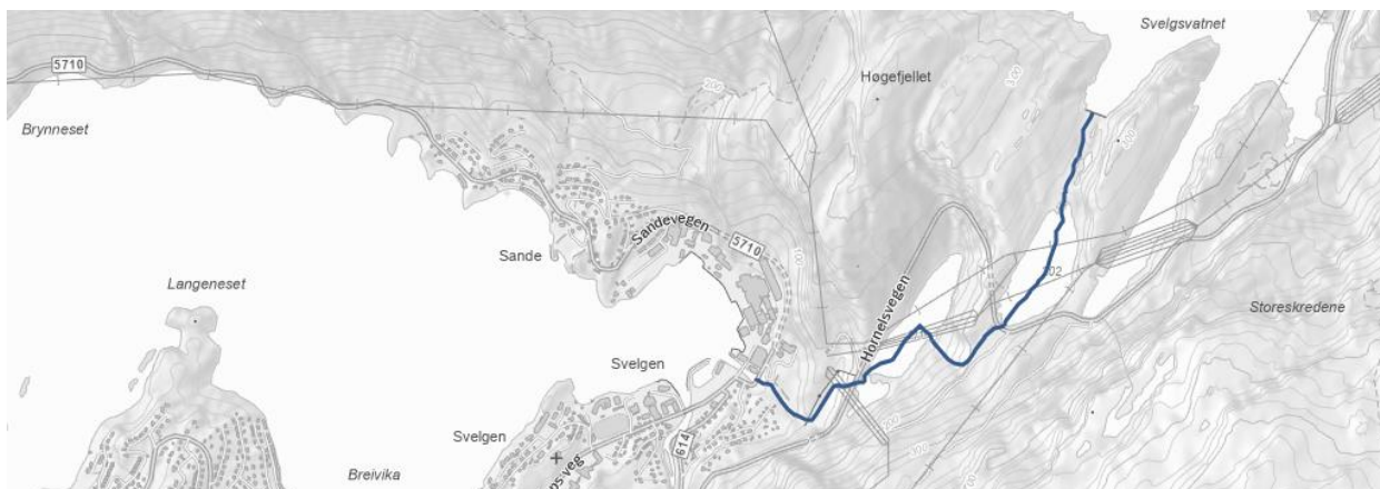
Figur 3-6. Vannforekomst Svelgselva (markert med mørk blå strek). Vannforekomsten er sterkt modifisert som følge av vannkraftutbygging. Hentet fra Vann-nett.
