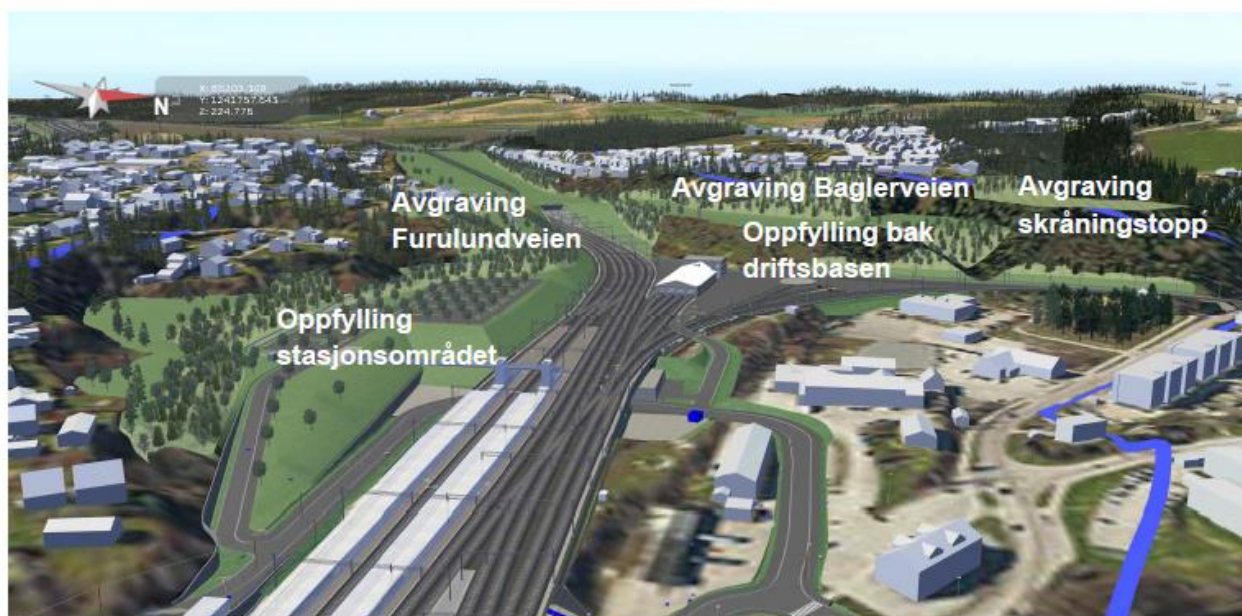
Figur 6-6: Oversikt terrenginngrep Hønefoss stasjon
