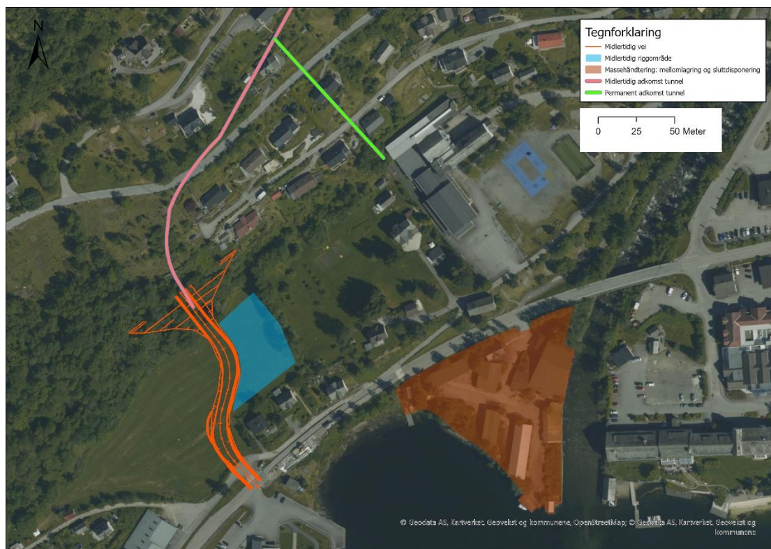
Figur 1-2: Illustrasjon av påhuggsområde i Ulvik sentrum med midlertidig anleggsvei og riggområde med mellomlagring av masser. Tunnelpåhugg blir i den bratte fjellskråningen under boligene på Skeie, mens masselagring planlegges på Brakanes på andre siden av fv. 572 jf. reguleringsplan for området. (arealplaner.no (kommune, 2016)).
