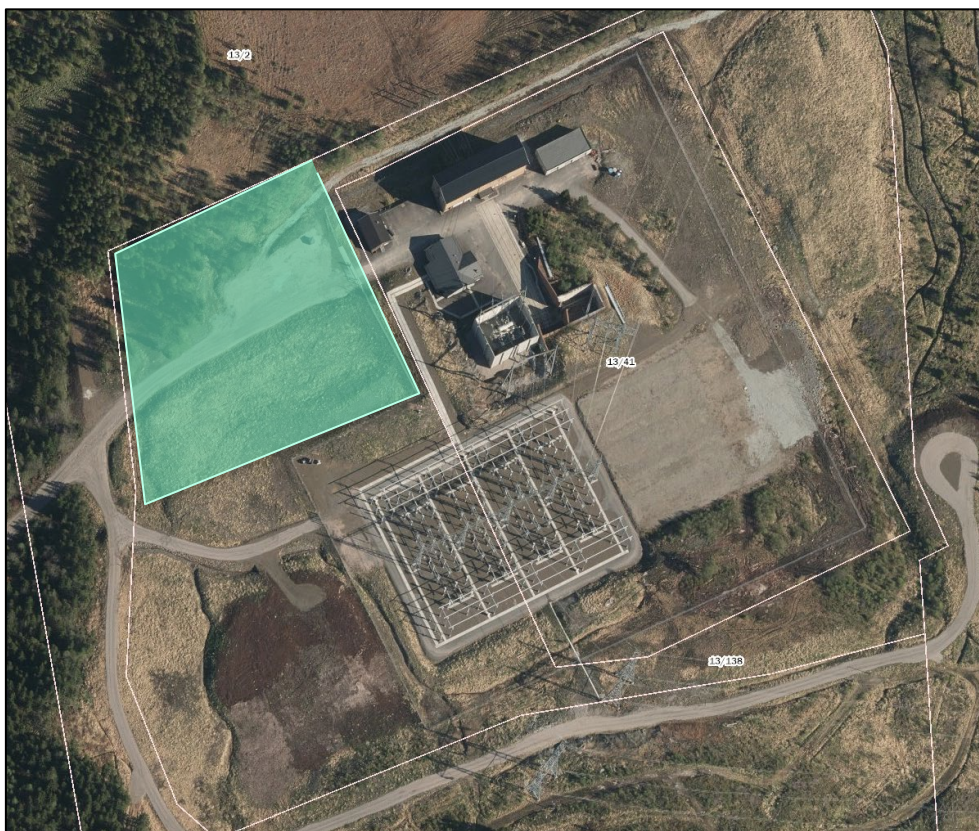
Figur 9: Namsos transformatorstasjon. Området som er markert er satt av for nytt 132 kV koblingsanlegg.
