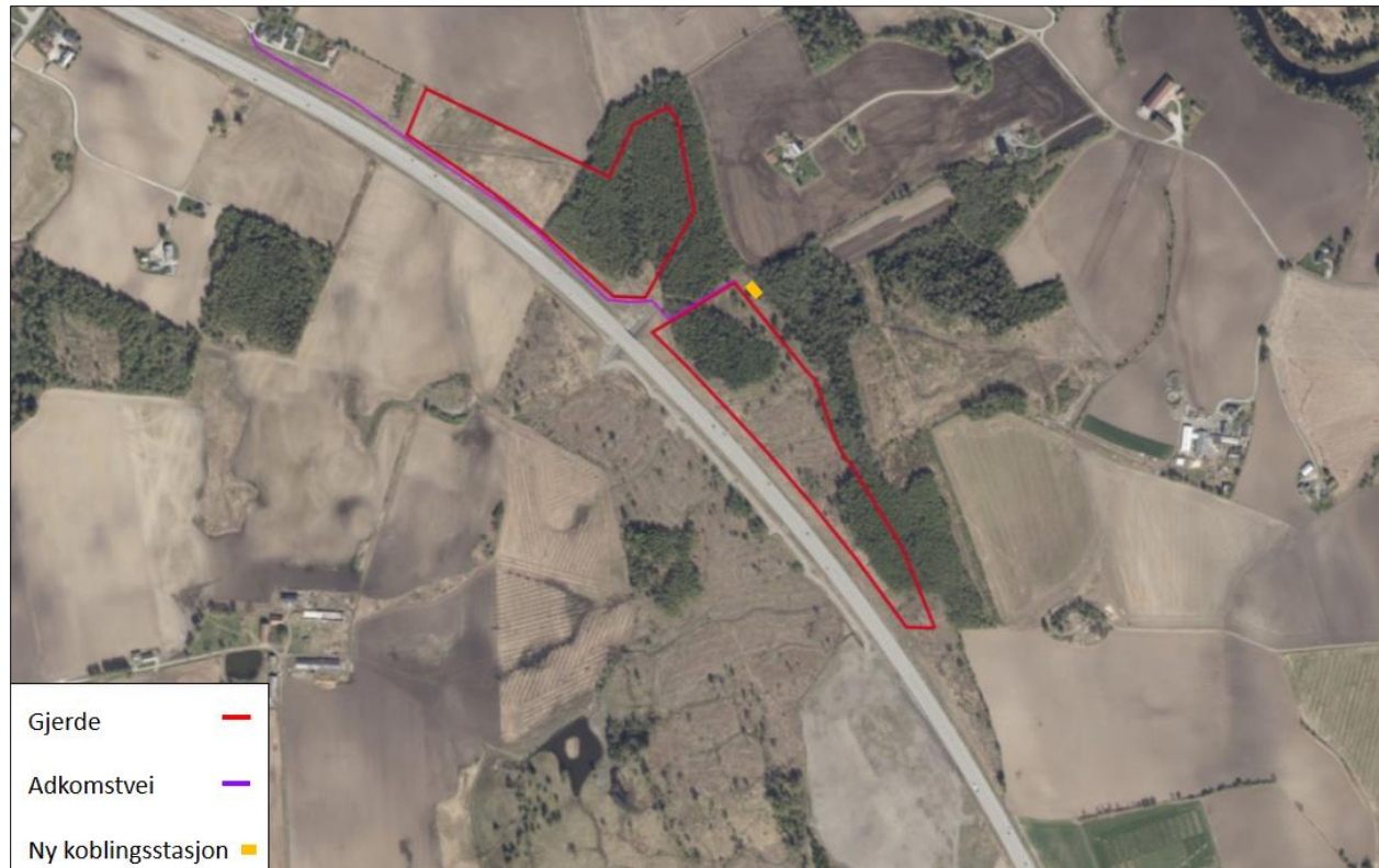
Figur 23: Tentativ plassering av ny koblingsstasjon.
