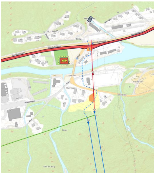
Figur 5-20: Grønn ledning skal rives. Her ved Mår kraftverk og kryssing av Rjukanbanen.
