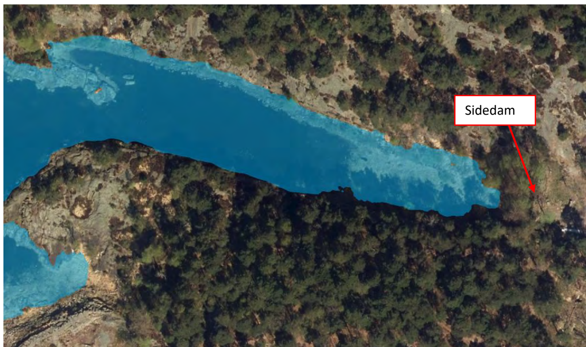
Figur 2-7: Ortofoto av sidedammen der maksimal flomvannstand for 1000-årsflom er visualisert
