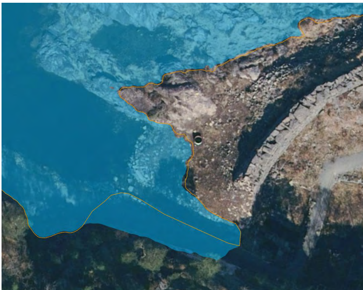
Figur 2-8: Forskjell i vannspeil fra dagens terreng (blå) og vannspeil ved hevet turvei (oransje)
