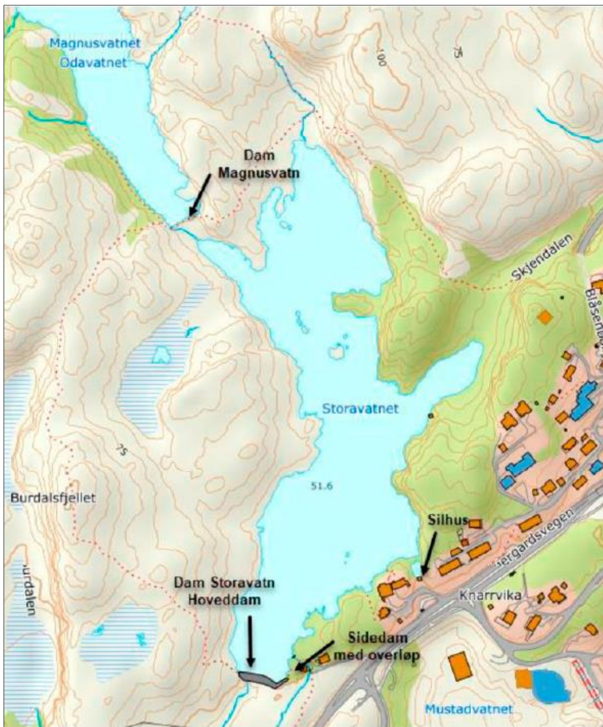
Figur 1-2. Oversikt over vassdragsanlegget. Dam Magnusvatn er ikke del av tiltaket. Figuren er hentet fra søknad om nedlegging.
