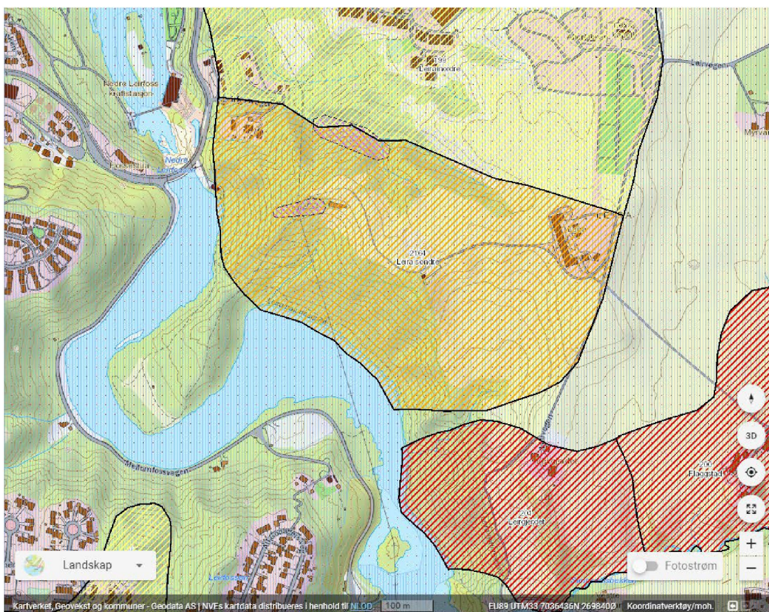
Figur 1. Oversiktskart viser kvikkleiresone 2164 Leira søndre og nabokvikkleiresoner. Kartet viser løснеområde (skravur) med potensiell fare for kvikkleireskred. Fargene angir faregrad (rød=høy, oransje=middels og gul=lav). Sone 2164 Leira søndre har middels faregrad, alvorlig konsekvens og risikoklasse 4. (Utklipp fra NVE kvikkleirekart, dato 22.07.2020)
