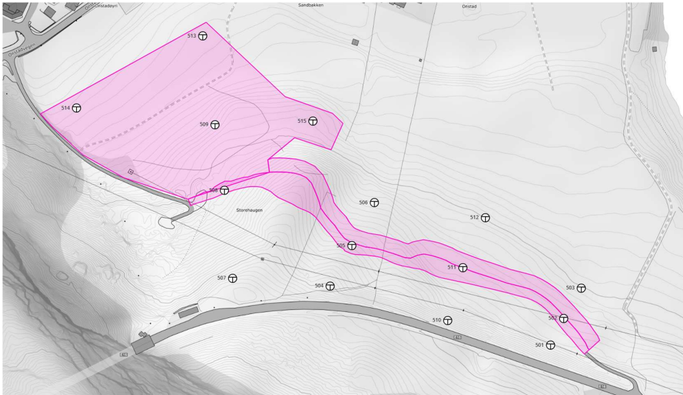
Figur 6-5: Forslag til borplan for grunnundersøkelser for utredning av områdestabilitet for planlagte tiltak ved Onstad.
