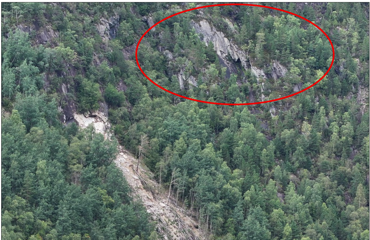
Figur 10: I nordaustleg del, der berggrunnen er tolka å bestå av kvartsitt, har fjellet høgare sprekkdanning og meir kaotisk sprekkesett. Noko av dette er grunna tidlegare utrasingar, og raud markering viser antatt losneområde for ei skredhending rundt 1973. Infopunkt 9.
