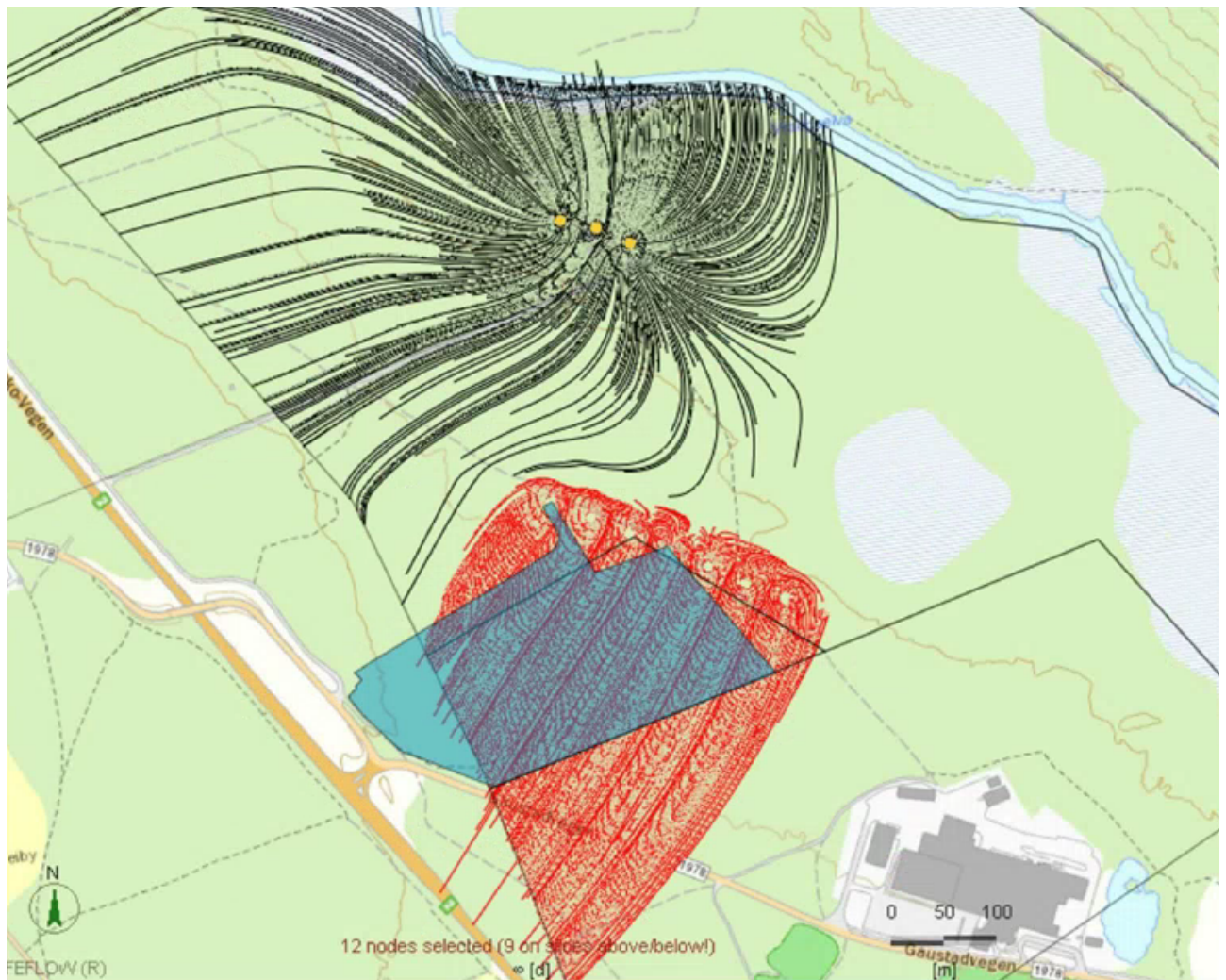
Fig 5. Industriområdet slik det er tegnet i planutkast fra Kommunen med avskjærende brønner og strømningslinjer lagt inn. (Isolasjon av nytt industriområde 25.06.2020)
