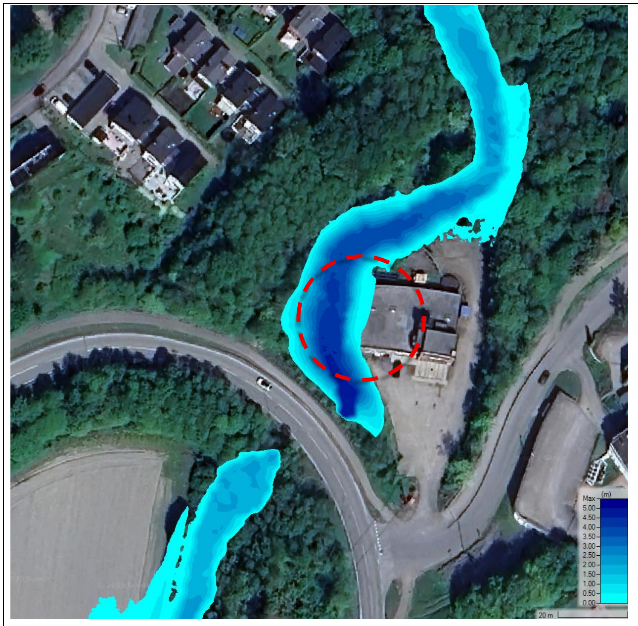
Figur 6-2: Vanndybde ved dimensjonerende flom.
