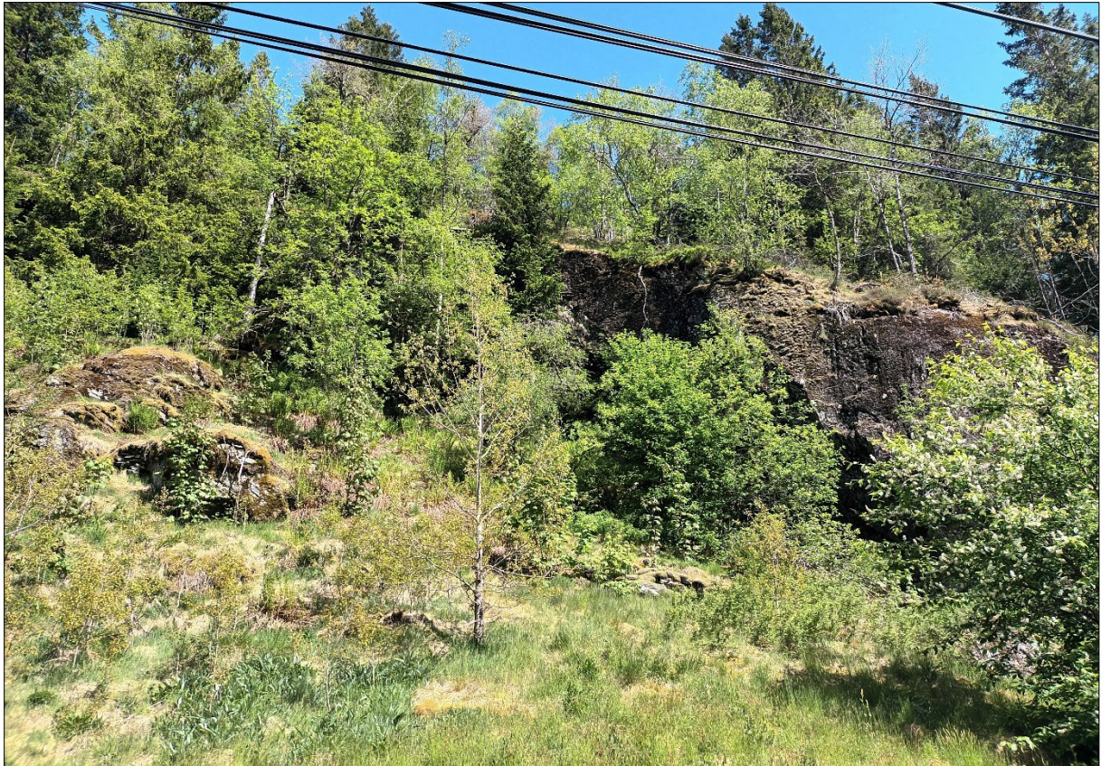
Figur 13: Lausmassane i nedre del av påverknadsområdet består av grovt, gammalt skredmateriale (>1000 år) over fast fjell. Skredmateriale er hovudsakleg konsentrert tett på hammarpartiet langs austleg del av skaret. Infopunkt 4.
