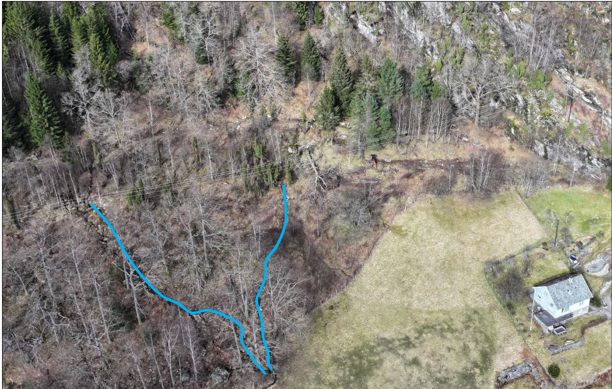
Figur 28: Dronebilde viser at det er små bekkar i nedre del av fjellsida, men at desse blir utydelege høgare opp i fjellsida. Det er tolka at dreneringa hovudsakleg renn som overvatn høgare i påverknadsområdet før den blir konsentrert i nedre del (markert med blå linjer). Bekkane renn ut sørvest for kartlagt område.
