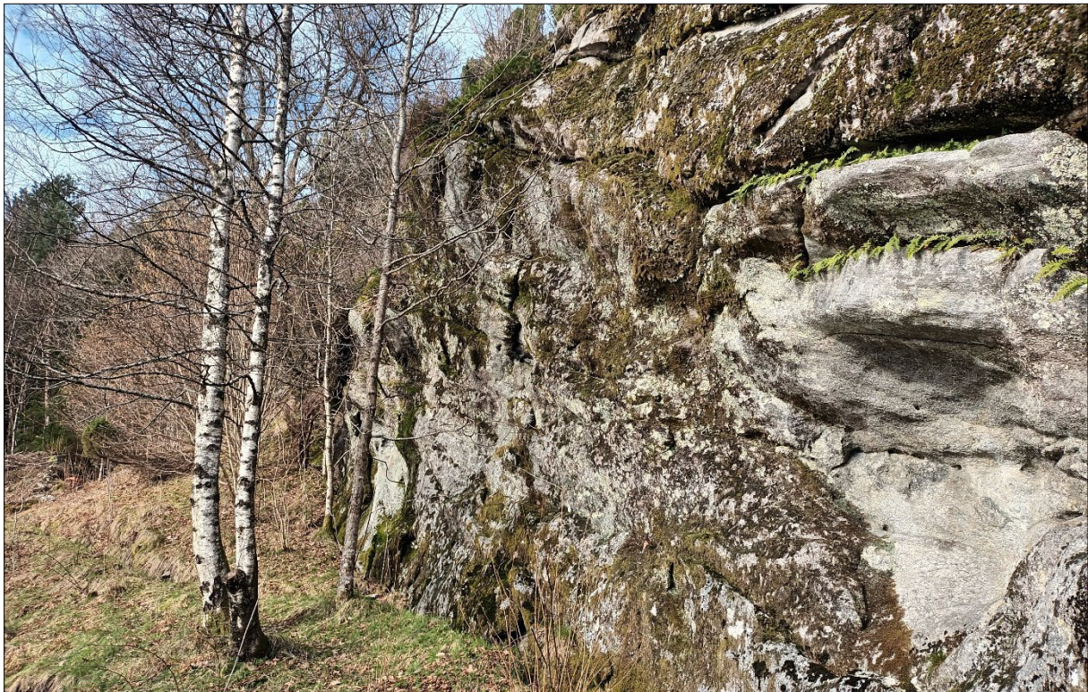
Figur 10: Sørøstleg del av hammarpartiet, nedst i påverknadsområdet, er hovudsakleg vurdert som massivt utan vesentleg sprekkdanning eller ustabile strukturar. Infopunkt 1.
