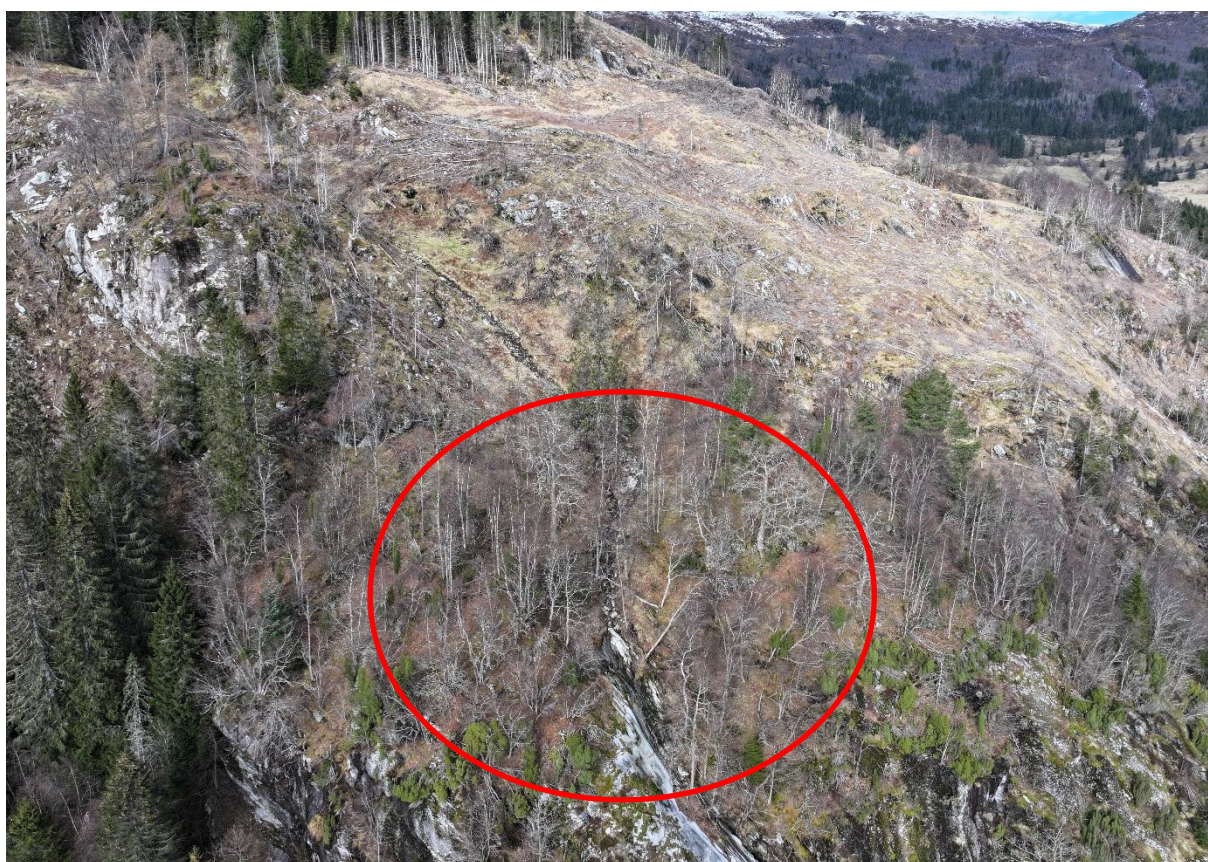
Figur 31: Modelleringar viser at skogen (raudt omriss) og terrenget vil redusere hastigheita i eventuelle snøskred (som har nok volum/hastigheit til å nå forbi svingpunktet i renna) i så grad at desse vil halde seg konsentrert i renna.
