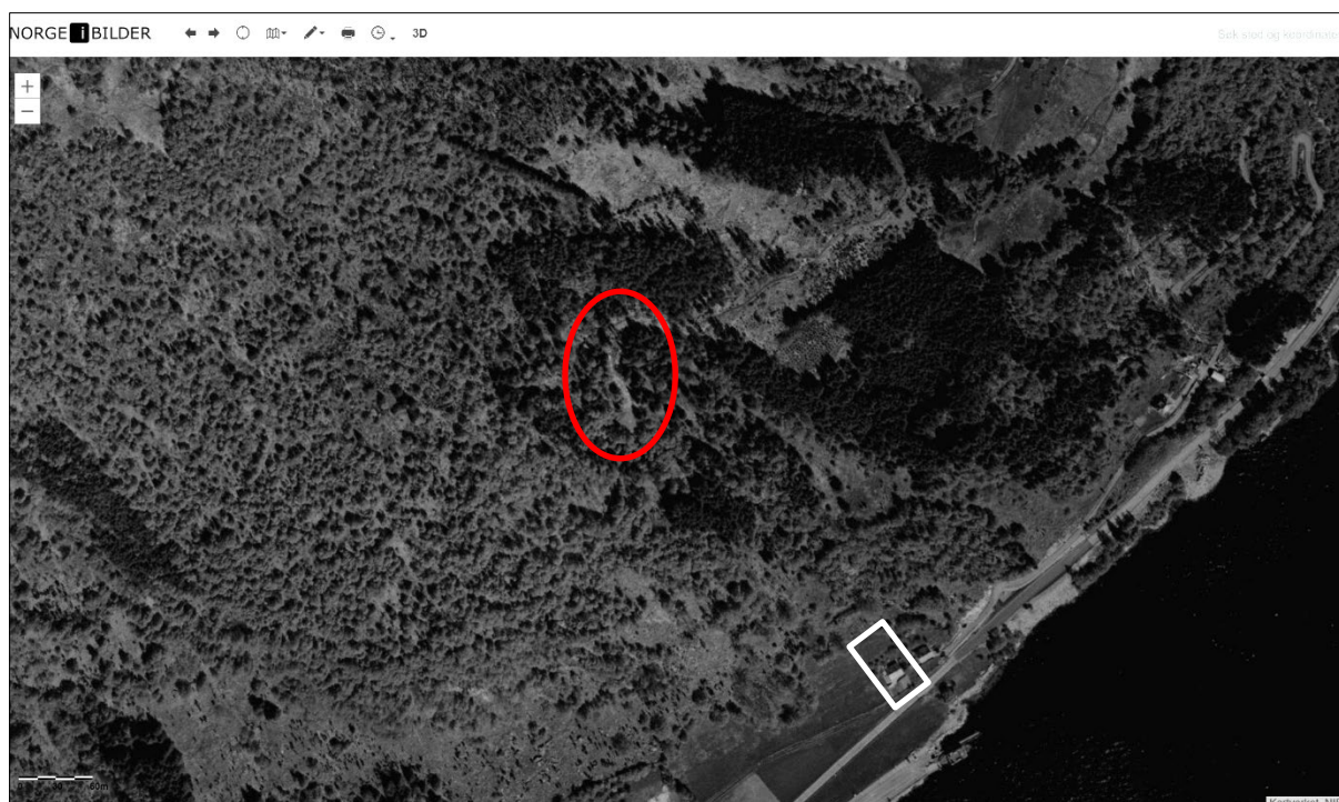
Figur 20: Flyfoto frå 1989 viser ei jordskredhending i øvre del av Gautegjelet (raud markering). Skredet er tolka å vere ei utgliding av ein skogsveg som skredet i 2024. Kartlagt område er innafør kvitt omriss.
