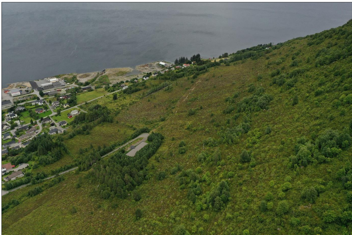
Figur 11: Oversiktsbilete som viser kartlagd område der lausmassane består av tjukk moreneavsetjing, oppover i fjellsida vert det gradvis tynnare dekke, der det går over til eit tynt lag organisk materiale over fast fjell mot toppen. Det er ikkje observert steinsprangblokker i kartlagd område, og relativt få i fjellsida ovanfor.
