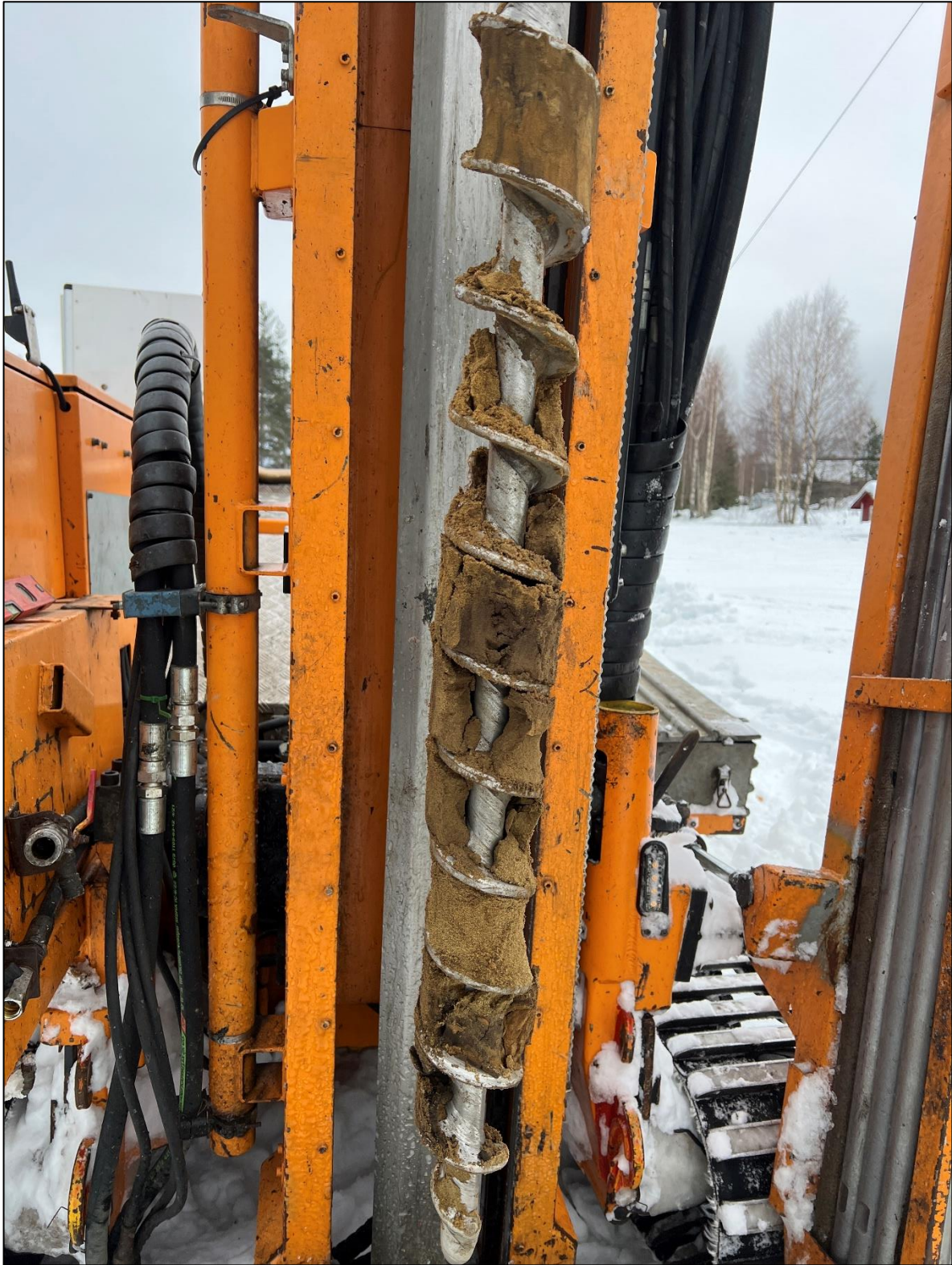
Figur 34. Borepunkt 27. Dyp 0,5-1,5 m. Foto: Romerike Grunnboring
