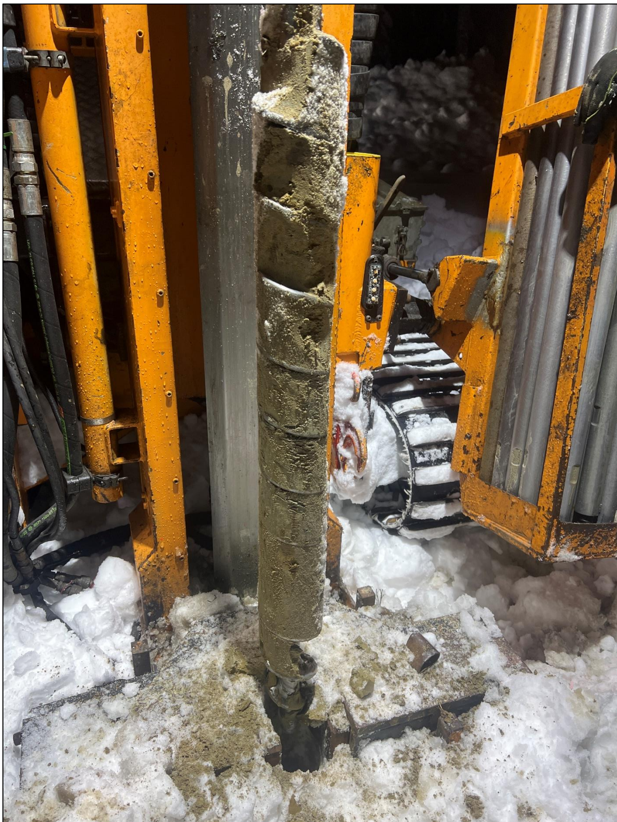
Figur 14. Borepunkt 6. Dyp 0,7-1,7 m. Foto: Romerike Grunnboring.
