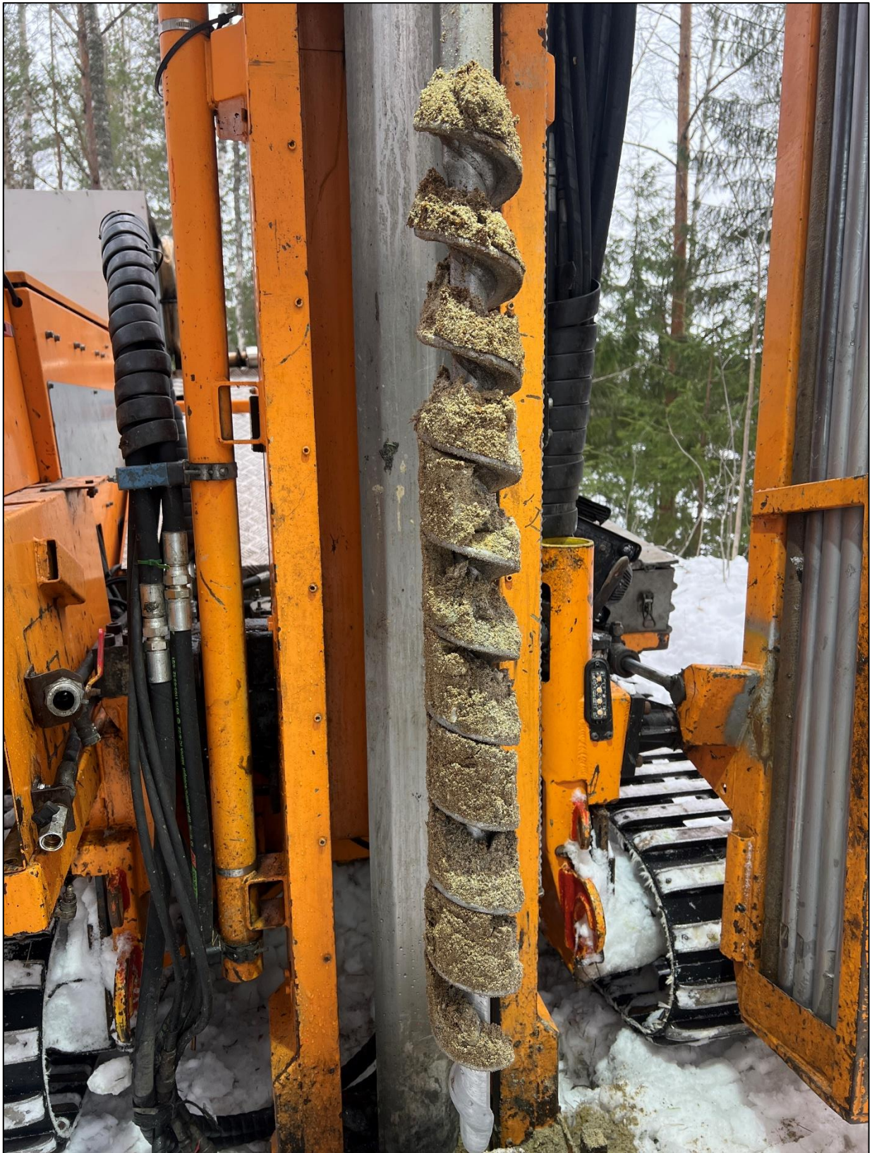
Figur 18. Borepunkt 11. Dyp 1-2 m. Foto: Romerike Grunnboring.
