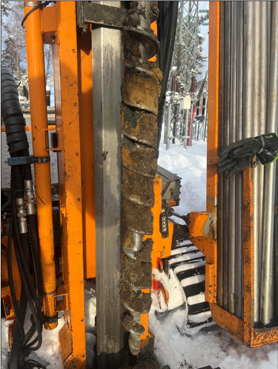
Figur 33. Borepunkt 21. Dyp 3-4 m. Foto: Romerike Grunnboring
