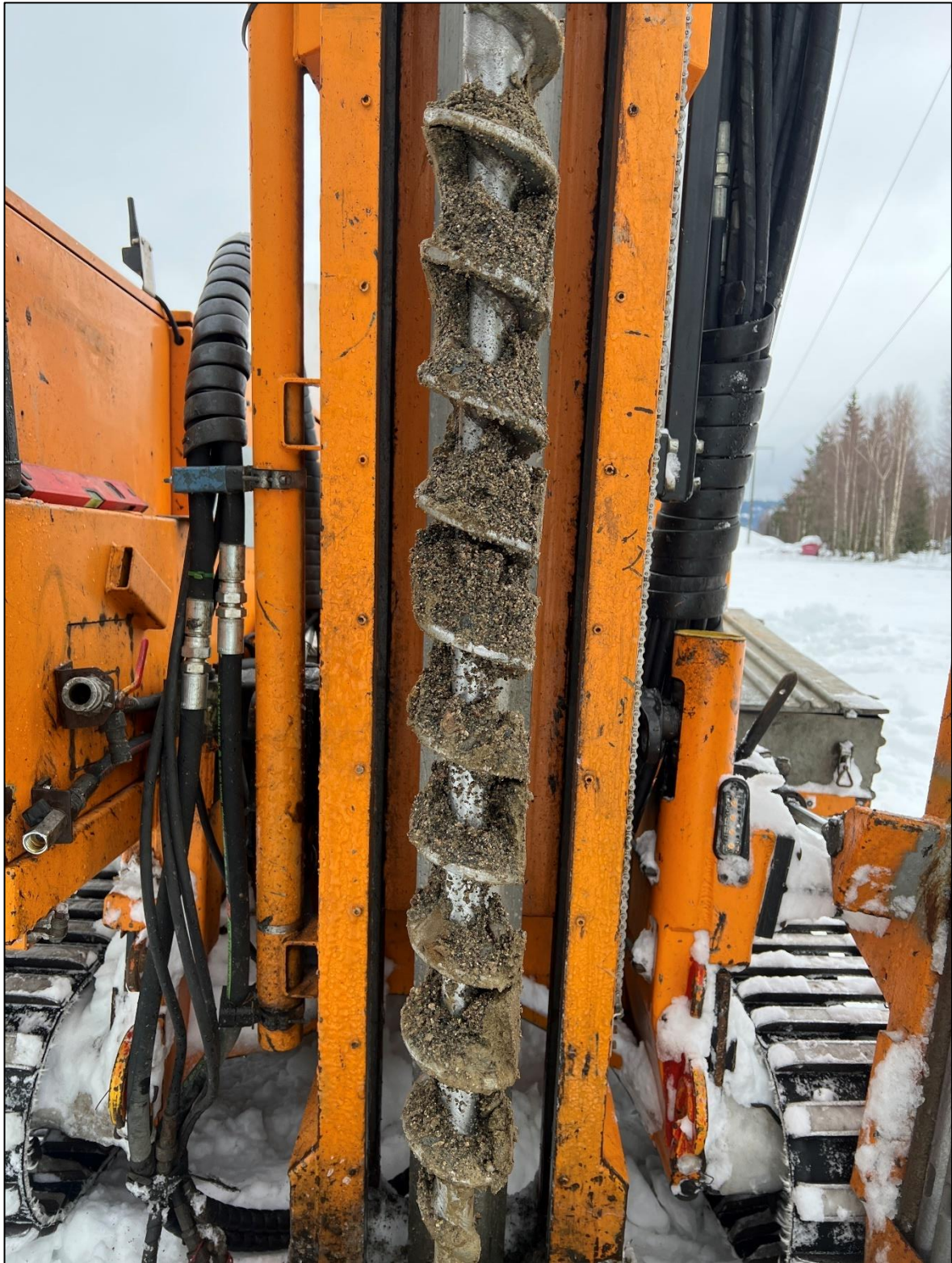
Figur 36. Borepunkt 27. Dyp 1,5-2,5 m. Foto: Romerike Grunnboring
