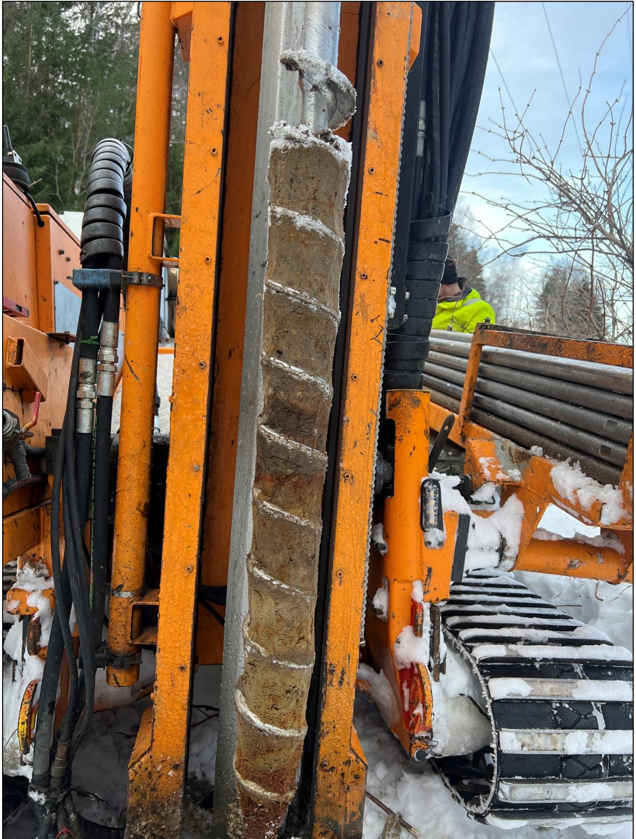
Figur 21. Borepunkt 13. Dyp 0-1 m. Foto: Romerike Grunnboring.
