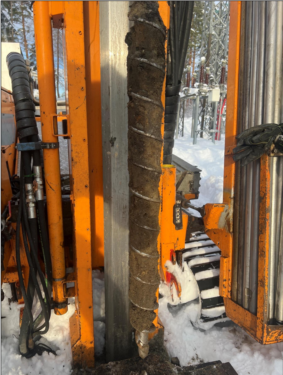
Figur 32. Borepunkt 21. Dyp 2-3 m. Foto: Romerike Grunnboring
