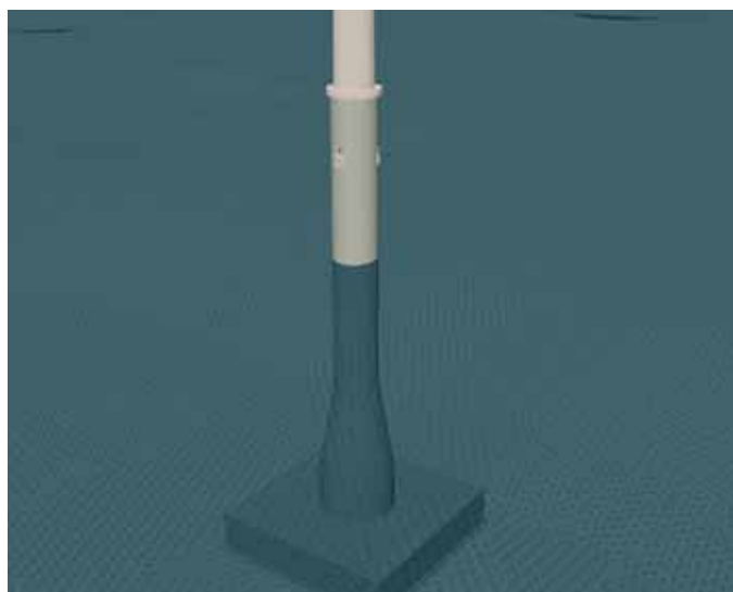
Figur 4. Illustrasjon av betongfundament for vindturbin. Kilde: SwecoGrøner.
