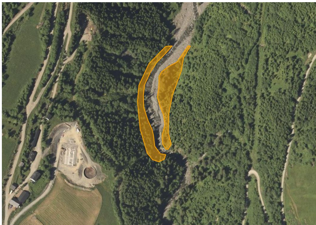
Figur 13. Område oppstrøms bunnlastsperren som må ryddes for vegetasjon (henholdsvis 3000 (venstre) og 3200 (høyre) m 2 ).
