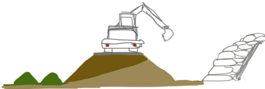
Figur 4.6 Anleggsfase: Topp- og undergrunnsjord skavet av, traktorvei gravd bort og masser fra den brukt i anleggsvei.
