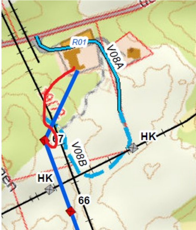
Figur 1. Blå heltrukken linje viser godkjent trase, mens rød heltrukken linje viser ny omsøkt trase. Turkis/lyseblå viser traktorvei (heltrukken linje) og barmarkstrase (stiplet).
