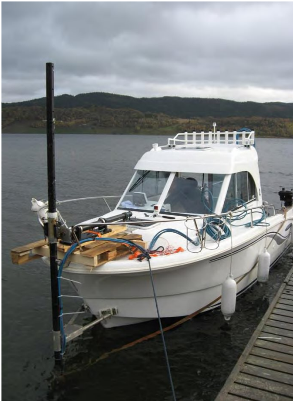
Figur 4: (Venstre) Foto av interferometrisk sidesøkende sonar montert på båten (Antares 650 Silver) i Botn. (Høyre) Foto av penetrasjons-ekkolodd under innsamling av refleksjonsseismiske data.
