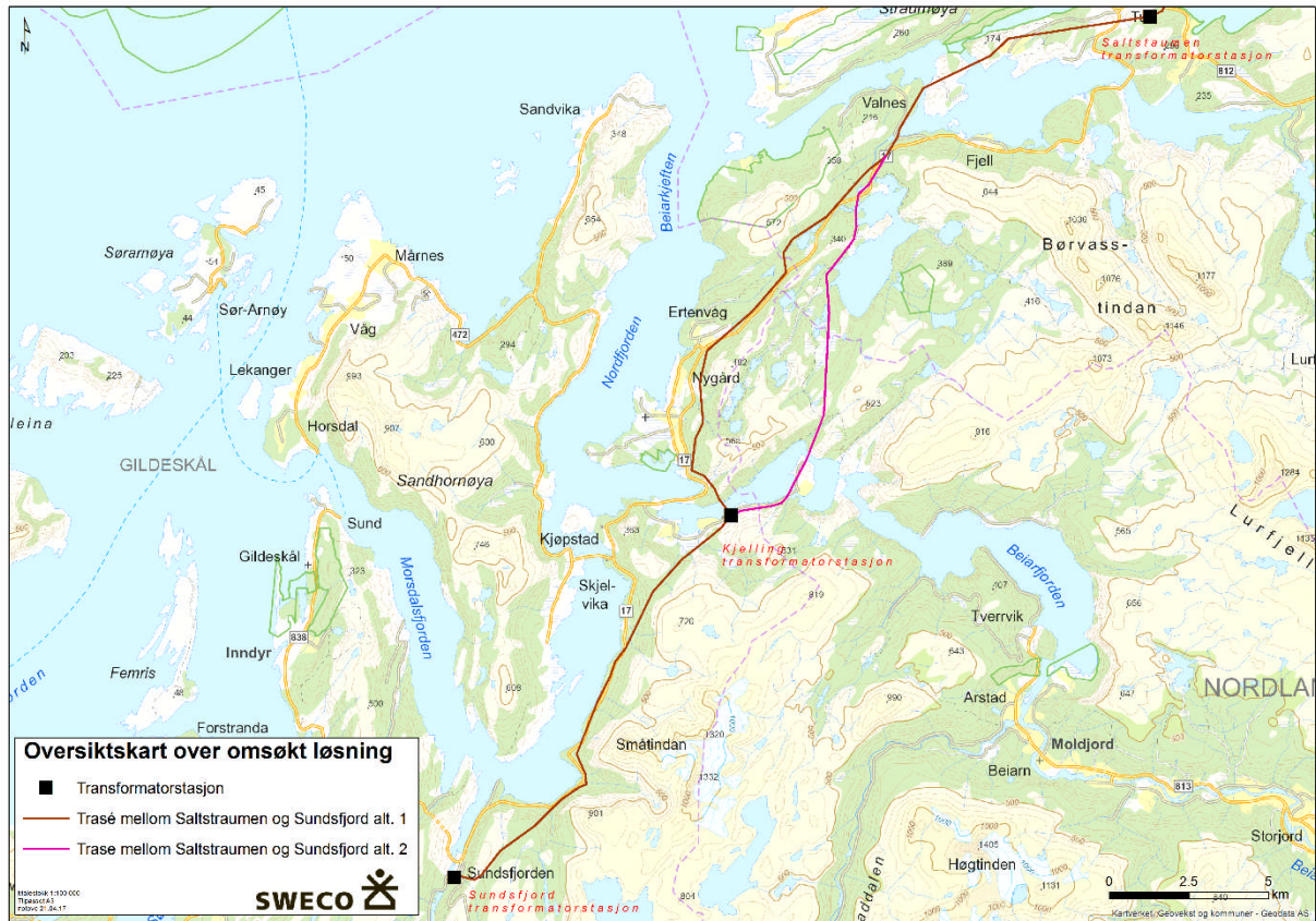
Figur 1-1: Kartet viser den omsøkte 132 kV luftledningen fra Sundsfjord transformatorstasjon til omsøkte Saltstraumen transformatorstasjon. Ledningen følger i hovedsak samme trasé som den eksisterende 132 kV ledningen Hopen – Sundsfjord, med unntak av en delstrekning mellom Kjelling og nordenden av Valnesvatnet der det er to alternative traséer.
