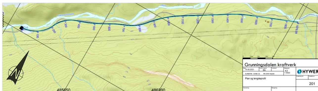
Figur 2-1 Utbyggingsløsning for Grunningsdalen kraftverk.
