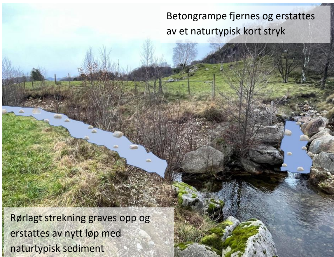
Figur 51. Prinsippskisse av fjernet rørlagt strekning i Vinninglandsbekken, samt fjernet betongrampe ned fra sideløpet. Se på Figur 48 for sammenligning med førtilstanden.
